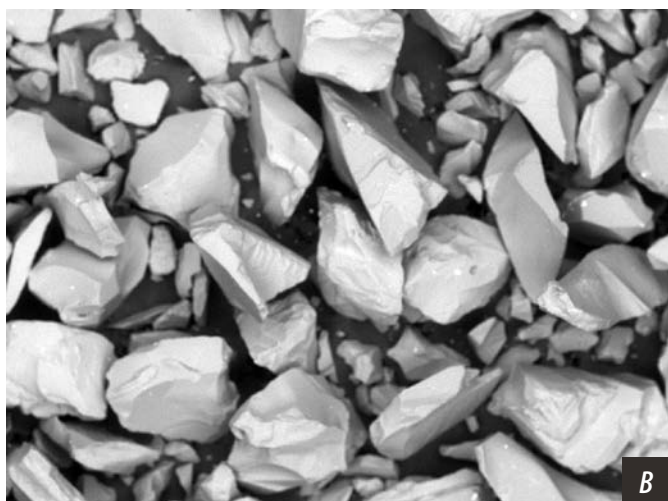
Рис. 1. Порошок электрокорунда зернистостью 90—106 мкм (А) и 250—300 мкм (В) при 100-кратном увеличении [Fig. 1. Electrocorundum with a grain size 90—106 microns (A) and 250—300 microns (B) at 100× magnification]
