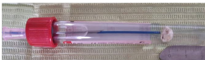
Рис. 1. Экспериментальная модель для исследования эффекта ретропульсии при дроблении сиалолита Fig. 1. Experimental model for the study of the effect of retropulsion during crushing of sialolite
