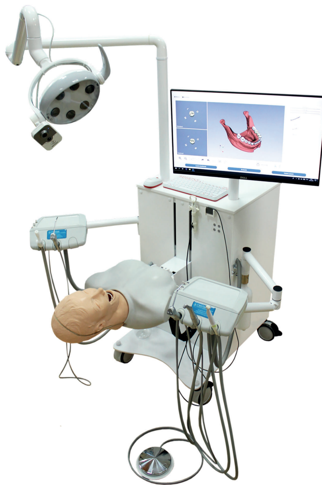
Рис. 3. Гибридный стоматологический симулятор с обратной связью и виртуальным трекингом
