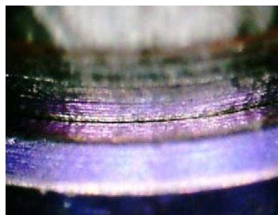
Рис. 3. Изображение в области соединения аналога имплантата с балочной конструкцией, изготовленной с помощью CAD/CAM-системы (×200) [Fig. 3. The image in the area of the connection of the implant analog with a bar construction made using a CAD/CAM system (200×)]
