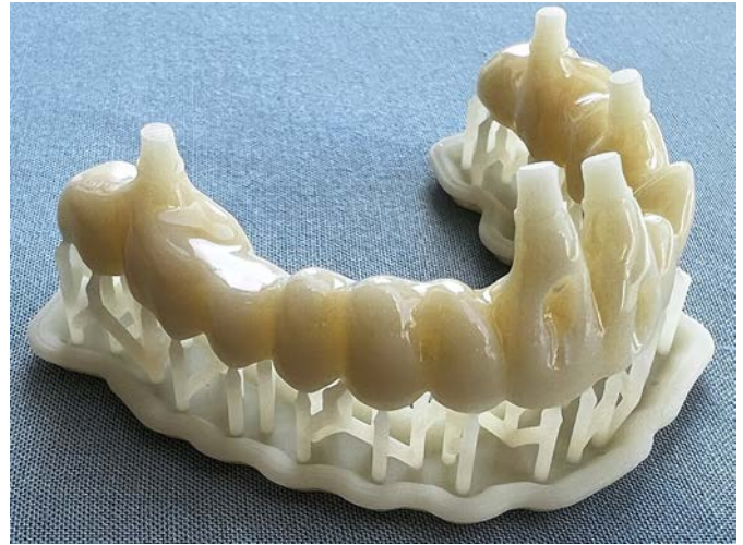
Рис. 3. Временная реставрация, изготовленная методом 3D-печати [Fig. 3. Temporary restoration made by 3D printing]
