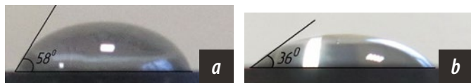
Рис. 5. Краевой угол смачивания: а — окисной пленки титана ВТ6; б — покрытия Pateks [Fig. 5. The wetting angle of: a — the oxide film of titanium grade 5; b — Pateks coating]
