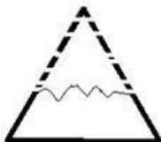
Рисунок 1д. Зерно после повторного разрушения, и восстановления силы резания.
