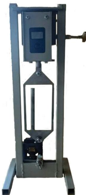
Рис. 1. Установка для измерения адгезионной прочности
