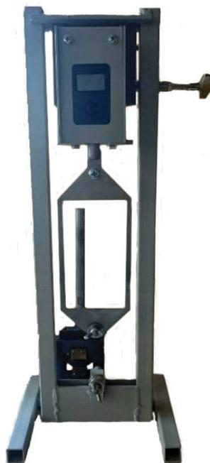
Рис. 1. Установка для измерения адгезионной прочности
