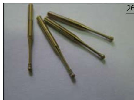
■Рис. 2. Алмазные боры “РосБел”: а) без покрытия; б) с нитрид-титановым покрытием (TiN); в) покрытые двойным нитридом (Ti,Al)N
