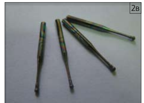
■Рис. 2. Алмазные боры “РосБел”: а) без покрытия; б) с нитрид-титановым покрытием (TiN); в) покрытые двойным нитридом (Ti,Al)N
