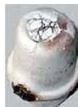
Рис. 3. Характер разрушения тигля
