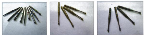
Рисунок 6. Алмазные боры «РосБел»: а) без покрытия; б) с нитрид-титановым покрытием (TiN); в) покрытые двойным нитридом (TiAl)N.
