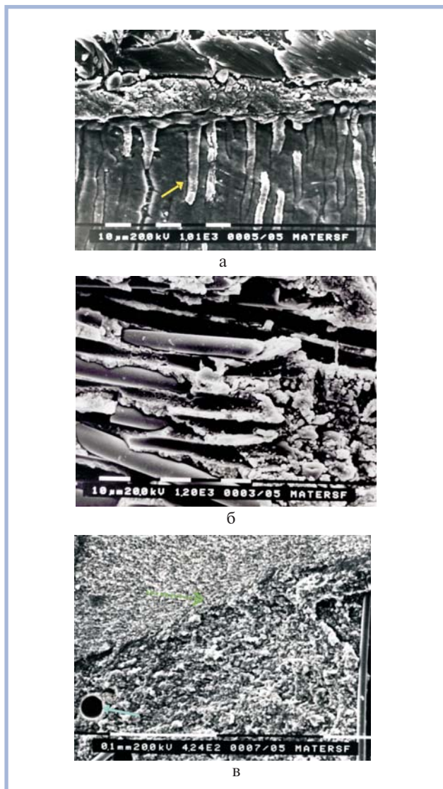
Рис. 5. Сканирующая электронная микроскопия срезов зубов армированных материалом «Superfiber».
