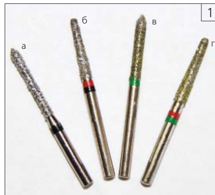
■Рис. 1. Боры стоматологические «РосБел», производство «ВладМиВа»: а) бор 220-160 мкм; б) бор 220-160/63-50 мкм; в) бор 160-125 мкм; г) бор 160-125/63-50 мкм
